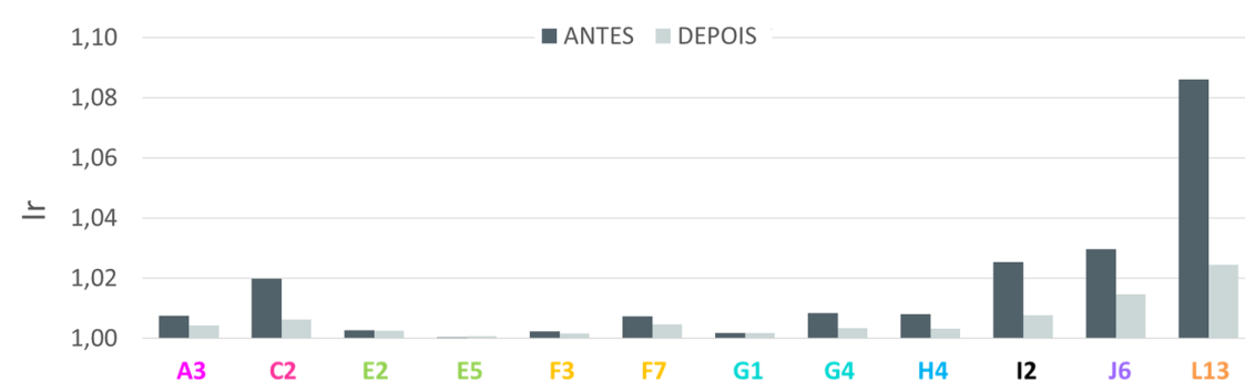
Figura 4.26 Índice de rugosidade obtido pelo perfilômetro mecânico, I_r , antes e após 6 meses de uso das amostras.
