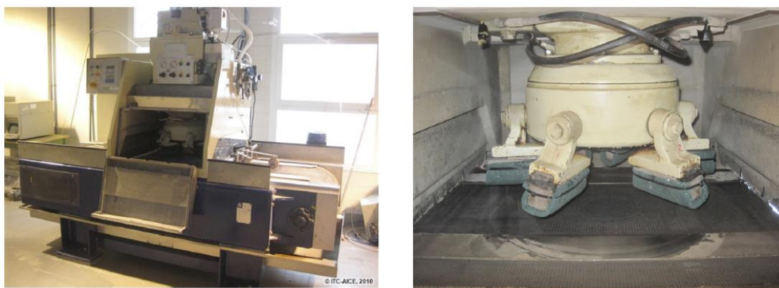
Figura 2.22 Máquina e cabeças polidoras giratórias sobre amostras [85].
