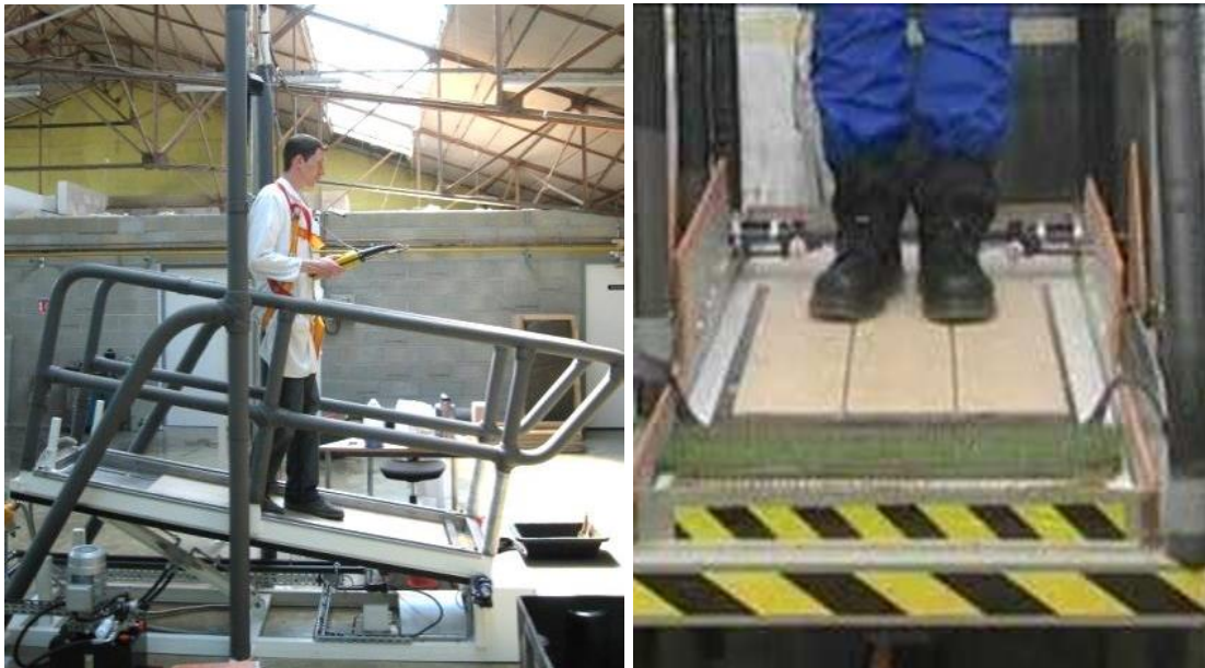
Figura 2.8 Execução do teste da rampa por um operador [58,59].
