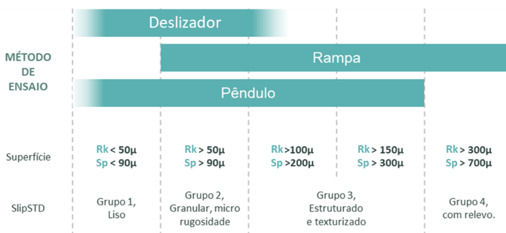
Figura 2.18 Idoneidade dos diferentes métodos de ensaio de escorregamento em função das características das superfícies [84]
