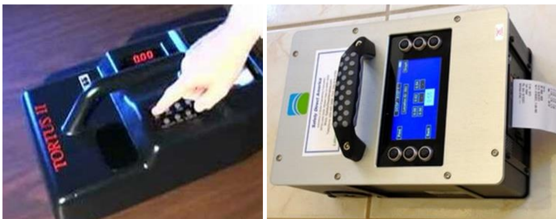
Figura 2.7 Deslizadores motorizados: Tortus e BOT-3000E [51].
