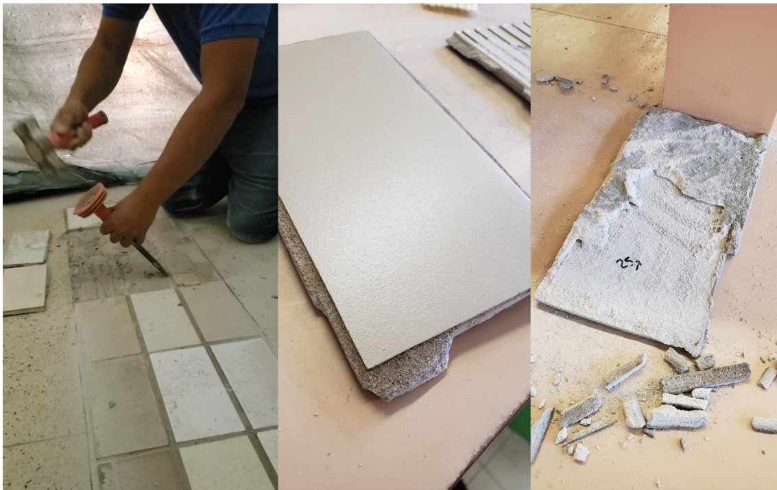
Figura 3.4 Remoção das amostras da área do experimento no Restaurante universitário da UFSCar e uma das placas removidas.
