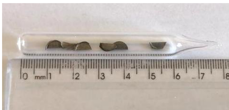
Figura 4.7 - Amostras D700 seccionadas ao meio e encapsuladas à vácuo em cápsulas de quartzo.
