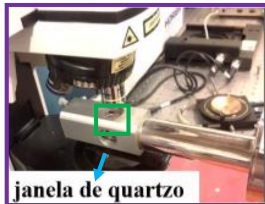
Figura 19 — Criostato Janis CCS-350S de ciclo fechado (móvel) acoplado ao espectrômetro Raman e o porta amostra adaptado para pós. Fonte: Foto adaptada da referência [63] .
