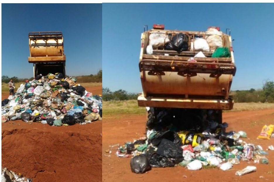
Figura 7 - Descarregamento dos resíduos sólidos
