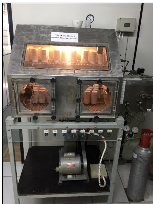
Figura 20 - Câmara de carbonatação com corpos de prova
