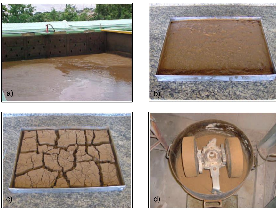
Figura 6 - Etapas de coleta e preparação do LETA onde: a) LETA na estação; b) LETA antes da secagem; c) LETA após a secagem em estufa; e d) Moagem dos torrões de LETA
