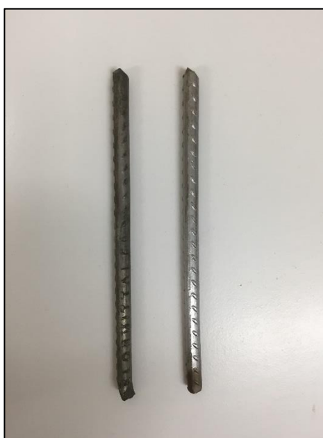
Figura 29 - Comparação entre barra totalmente exposta e isolada (fita isolante)
