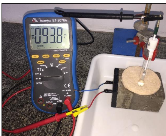
Figura 18 - Medição de PCA utilizando multímetro de alta impedância
