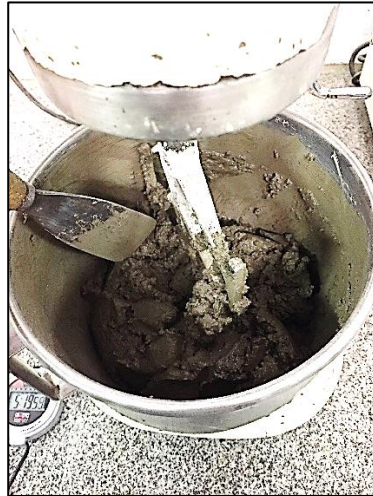
Figura 14 - Processo de mistura na argamassadeira
