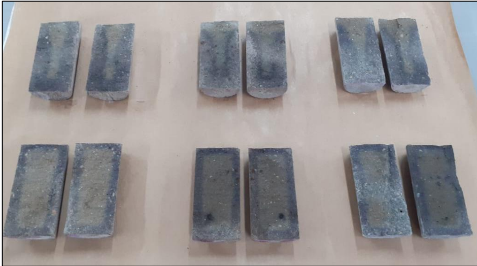
Figura 23 – Corpos de prova após aplicação da solução de nitrato de prata
