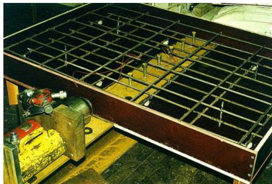
Figura 2.11: Arranjo do ensaio de cisalhamento direto de Lam (2007)
