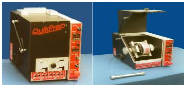
FIGURA 4.1 - Cromatógrafo de Contracorrente de Alta Velocidade (High-speed counter-current chromatography, HSCCC) Fonte: Cazal, (2010).
