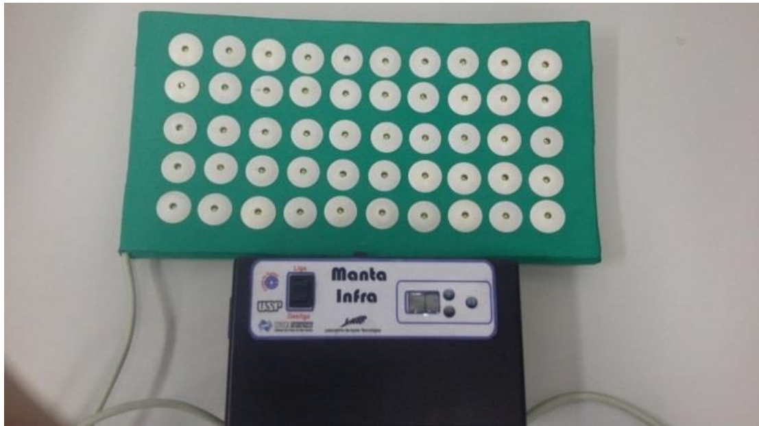
Figura 3. Equipamento para terapia por fotobiomodulação, composta por 50 diodos emissores de luz (LEDs) com comprimento de onda de 850 \pm 20 nm, potência de 75mW e área do feixe de saída de 0,20\text{cm}^2 em cada LED.
