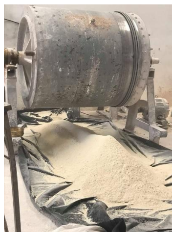
Figura 3.6 - Moinho descarregando pó de vidro
