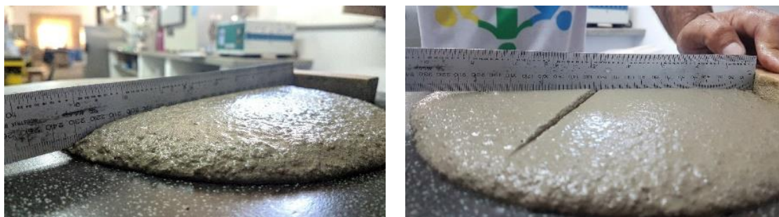
Figura 3.11 - Medição dos diâmetros para determinação da consistência da argamassa
