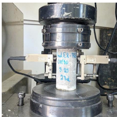
Figura 3.17 - Ensaio de módulo de elasticidade estático
