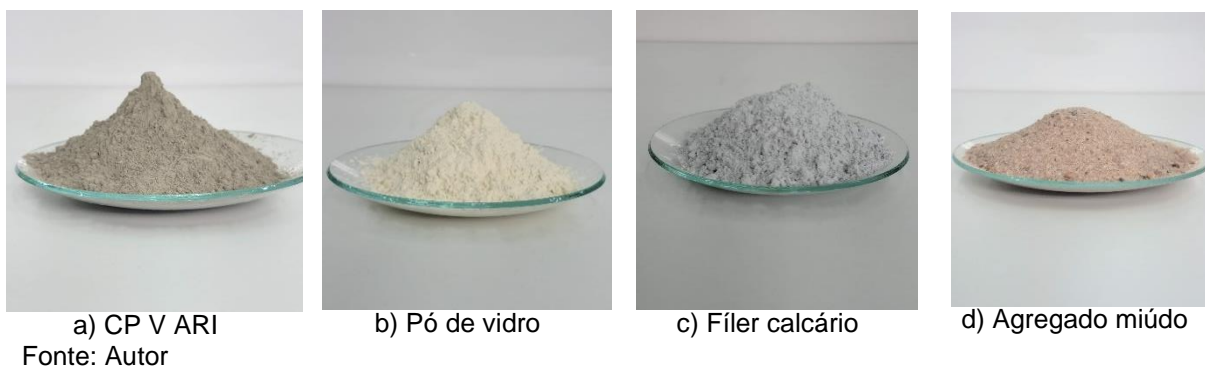
Figura 3.3 - Materiais utilizados: a) CP V ARI, b) pó de vidro passante pela #200, c) fíler calcário e d) agregado miúdo.
