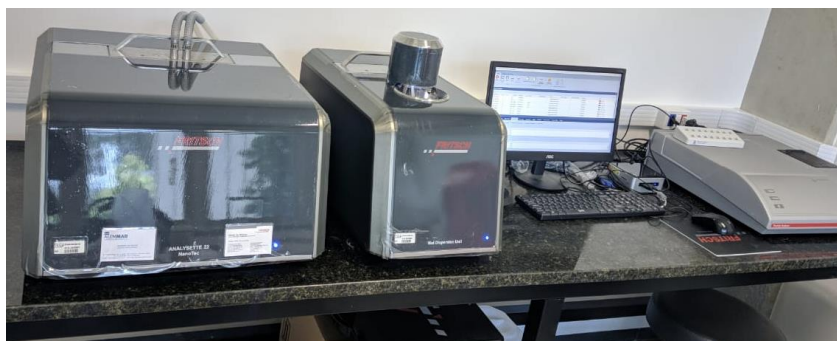
Figura 3.4 - Aparelhagem utilizada na realização da granulometria a laser
