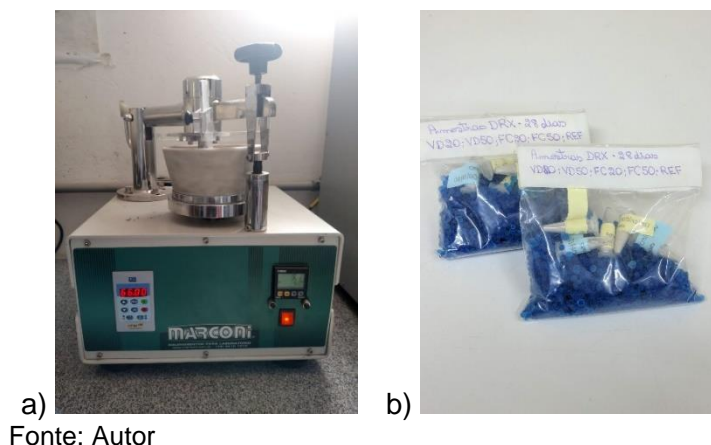
Figura 3.20 - Preparação das amostras para ensaio de DRX: a) Moinho tipo almofariz-pistilo. b) Amostras armazenadas.
