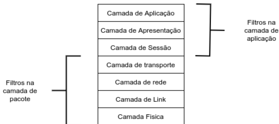
Figura 3 – Arquitetura de firewall com relação ao modelo OSI (adaptado [1])
