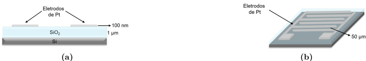
**Figura 2.2.2:** Representação do substrato com eletrodos de Pt utilizado para a deposição dos filmes de  $Zn_{1-x}Co_xO$ . (a) vista transversal e (b) substrato com eletrodos interdigitados, espaçados  $50\ \mu m$  entre os dígitos.
