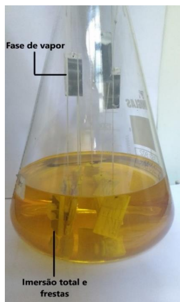
Figura 20 - Ensaio de imersão total, frestas e contato com fase de vapor.
