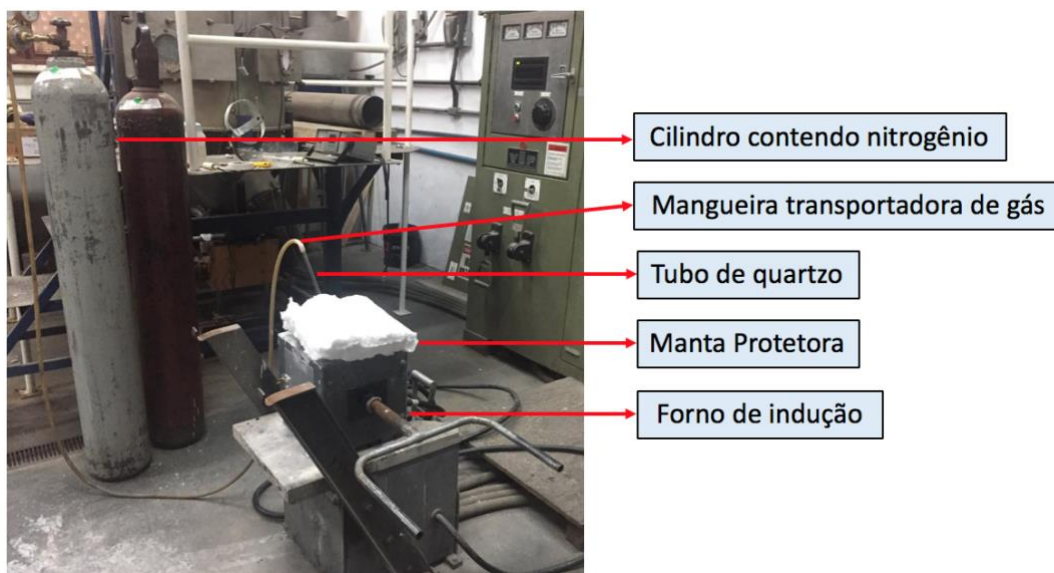
Figura 4.4 – Esquema do processo para obtenção da Liga Fe-B-N.
