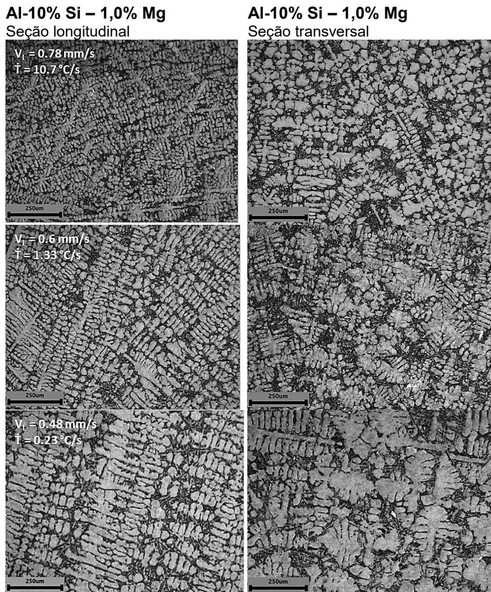
Figura 4.9. Microestruturas ópticas mostrando arranjos dendríticos e suas dependências com as taxas de resfriamento e velocidades de solidificação para a liga Al-10%Si-1,0%Mg.
