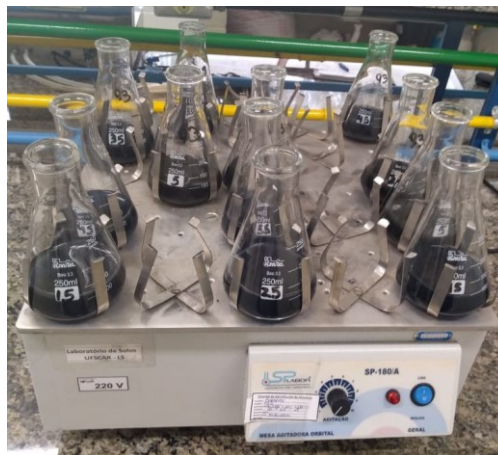
Figura 10 – Mesa agitadora Orbital sp labor modelo SP-180/a utilizado no estudo cinético
