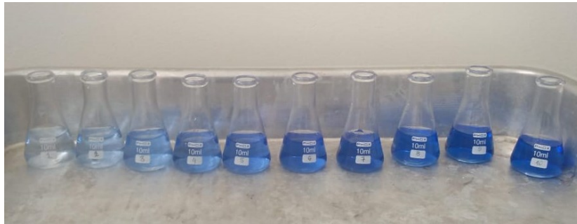
Figura 9 – Soluções diluídas a serem medidas em espectrofotômetro UV-VIS (190- 1100nm)
