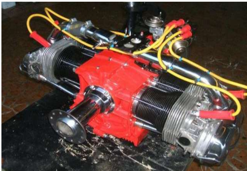
Figura 19 - Exemplo de adaptação de motor automotivo para uso em aeronaves
