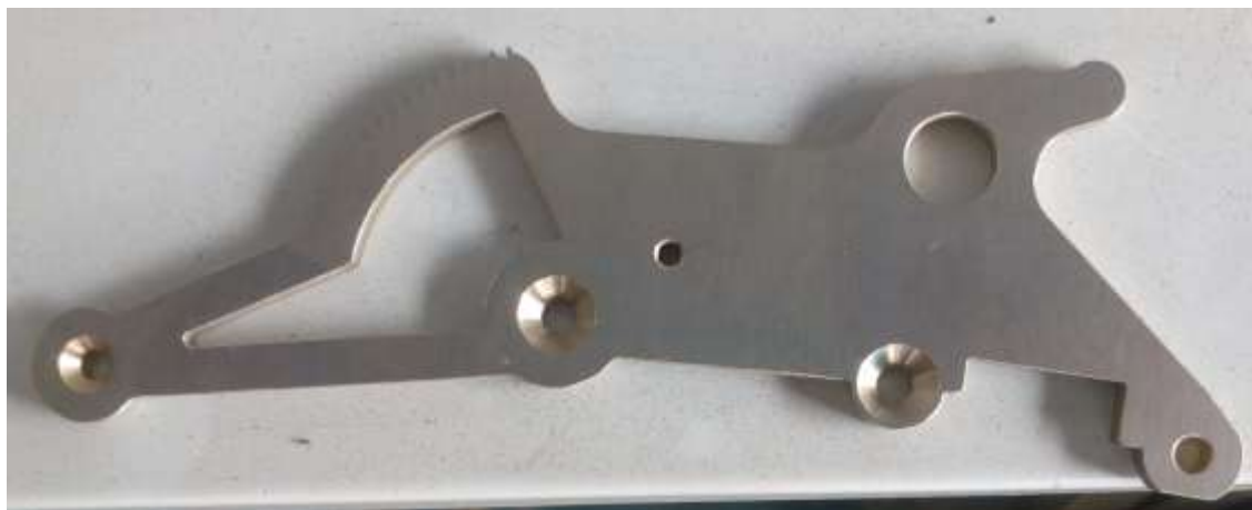
Figura 16 – Quadrante de comando produzida por meio de usinagem a laser
