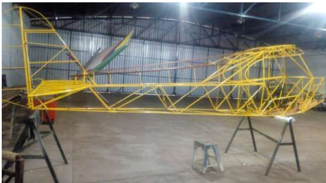
Figura 17 – Exemplo de estrutura tubular soldada utilizando processo TIG
