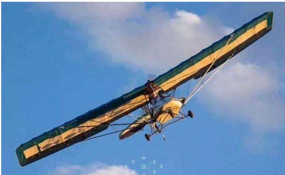
Figura 6 - Aeronave ultraleve básico modelo ML-300
