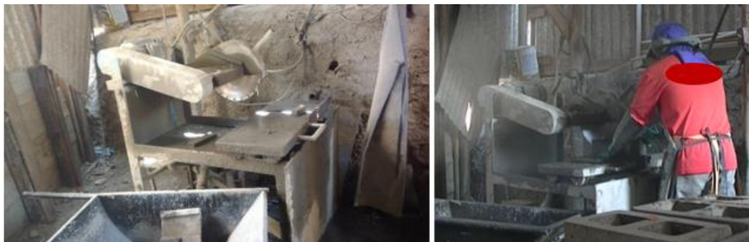
Figura 36 - Máquina de corte do bloco de concreto
