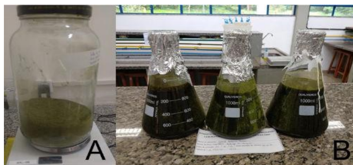
Figura 2. A: Folhas de R. communis trituradas; B: Matéria seca submetida a percolação com diclorometano.
