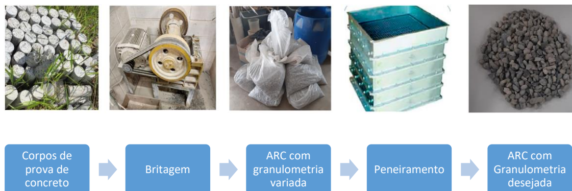
Figura 5-3: Processo de produção do agregado de resíduo de concreto
