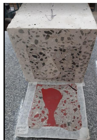
c) Exemplar A-CON-30%-3-1 Coesiva no concreto
