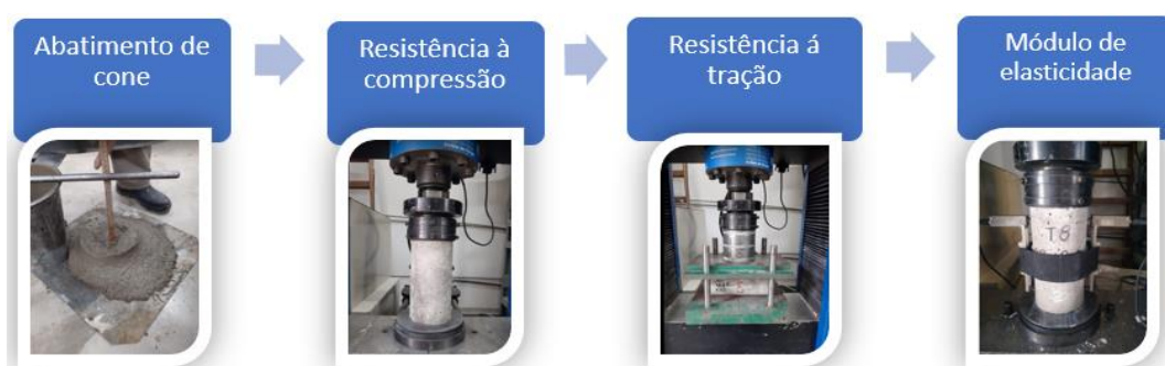
Figura 5-8: Ensaios de caracterização do concreto
