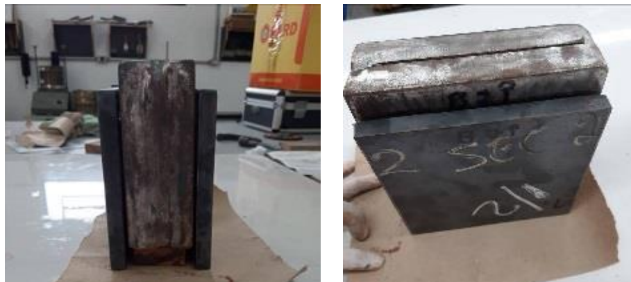
Figura 5-15: Modelo aço-epóxi-aço finalizado
