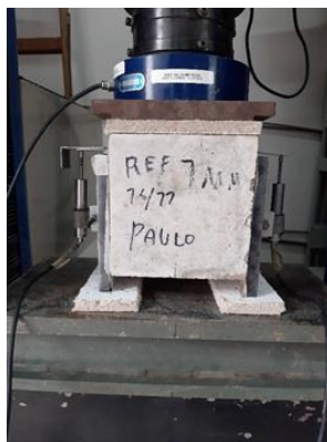
Figura 5-20: Ensaio de cisalhamento direto aço-epóxi-concreto
