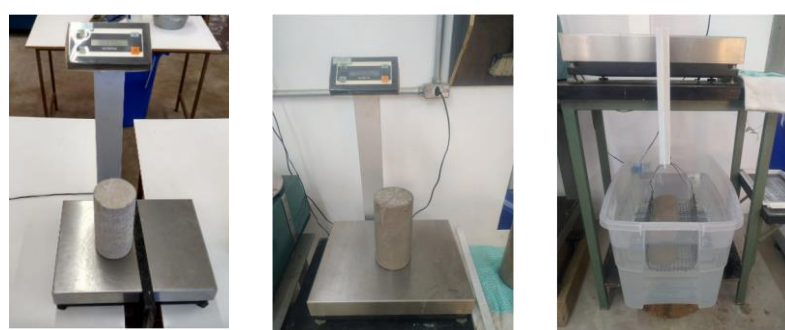
Figura 5-9: Ensaios de absorção de água, índice de vazios e massa específica
