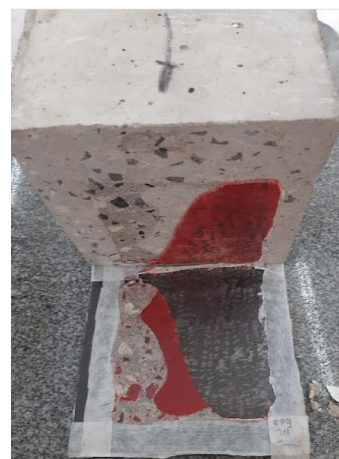
c) Exemplar A-CON-100%-3-1 Coesiva no adesivo
