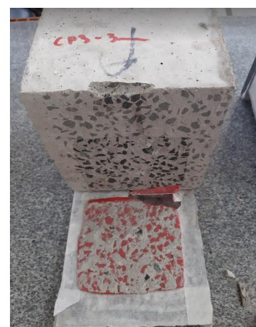
c) Exemplar A-CON-REF-3-3 Coesiva no concreto
