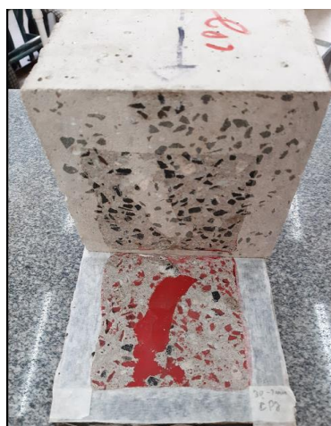
b) Exemplar A-CON-30%-2-1 Coesiva no concreto
