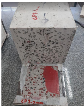
a) Exemplar A-CON-REF-1-1 Coesiva no concreto
