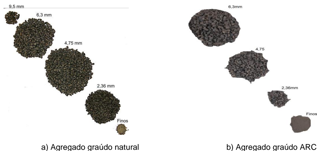
Figura 5-4: Faixas granulométricas dos agregados graúdos
