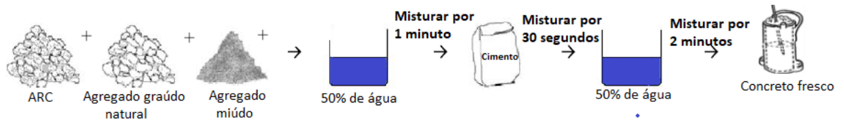
Figura 5-6: Método de mistura TSMA
