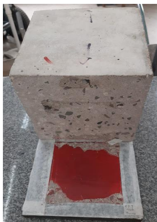
a) Exemplar A-CON-100%-1-1 Coesiva no concreto
