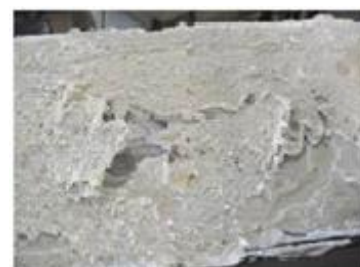
e) Ligação da viga P2 após o ensaio
