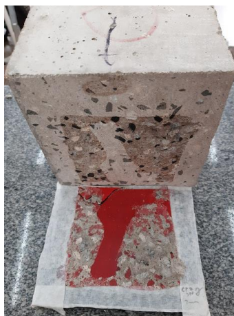
b) Exemplar A-CON-100%-2-1 Coesiva no concreto
