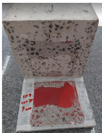
a) Exemplar A-CON-30%-1-1 Coesiva no concreto
