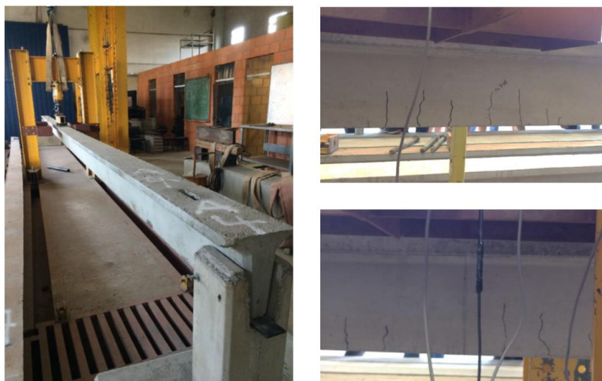
Figura 5-13: Ensaio de flexão positiva e configuração da fissuração - amostra A4
