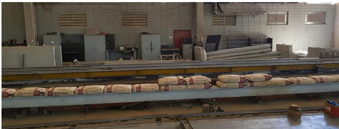
Figura 6-7: Carregamento com sacos de graute da amostra central A1P.
