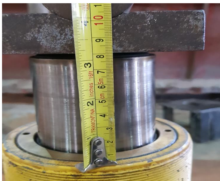
Figura 6-10: Trena utilizada medir o deslocamento do cursor do atuador hidráulico
