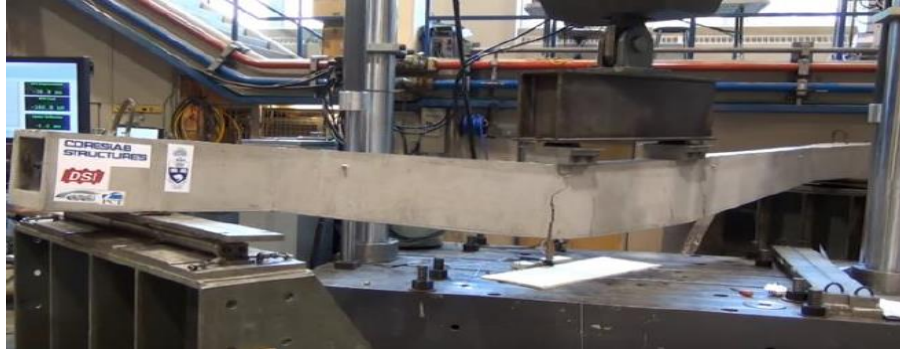
Figura 2-41: Ensaio de flexão em viga protendida.
