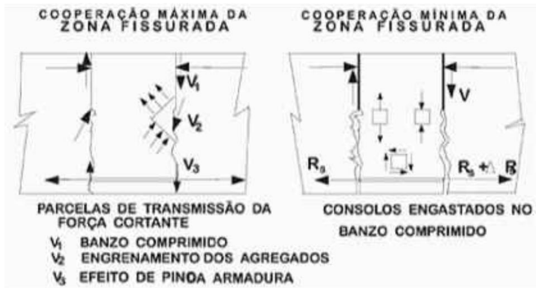
Figura 2-15: Resistência ao cisalhamento em peças fissuradas por flexão
