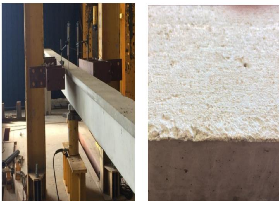
Figura 5-14: Ensaio de flexão negativa e configuração da fissuração - amostra A3
