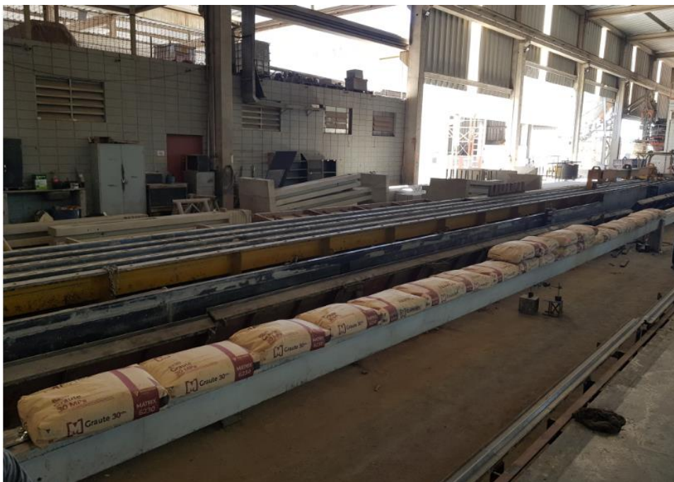
Figura 7-14: Execução do carregamento positivo na amostra A1P
