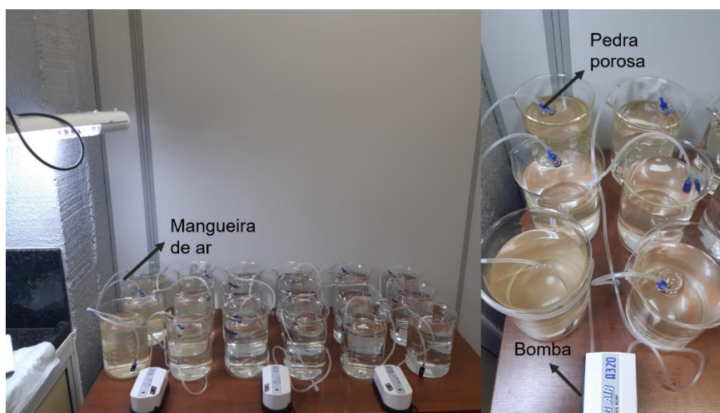
Figura 2.4 Ensaio de toxicidade aguda em Danio rerio (Zebrafish). Um sistema de aeração foi montado com o auxílio de bombas, mangueiras de ar e pedras porosas.
