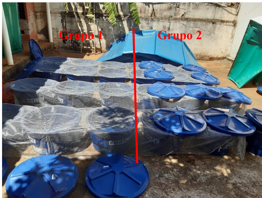
Figura 2.5 Ensaio de campo simulado com caixas d'água. À direita: caixas do grupo 1 que permaneceram abertas permitindo 100% a entrada de luz solar. À esquerda: caixas do grupo 2, cujas caixas tiveram 50% da luz bloqueada, simulando assim um ambiente sombreado.
