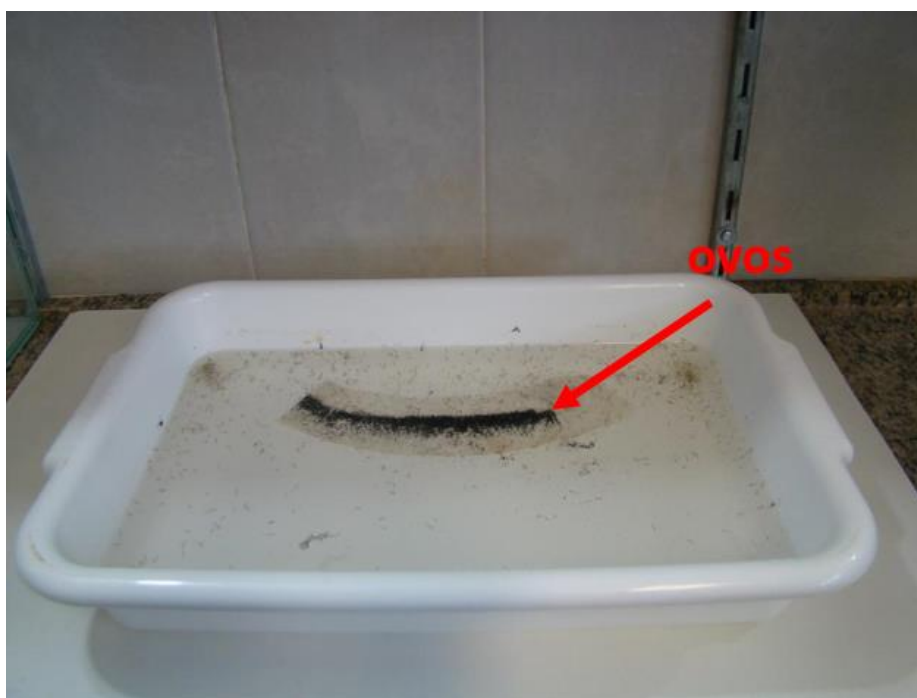
Figura 2.1 Bandeja plástica branca para eclosão dos ovos (substrato para oviposição: fita de papel filtro) de Ae. aegypti .
