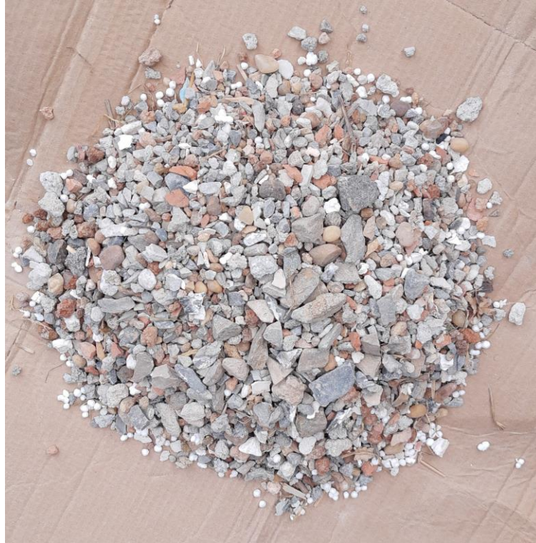
Figura 23 - Resíduo Agregado Graúdo (não passante na peneira de malha 4)
