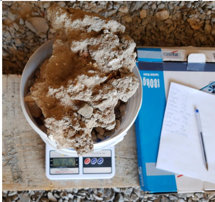
Figura 25 - Quantificação do Resíduo de Concreto e Argamassa
