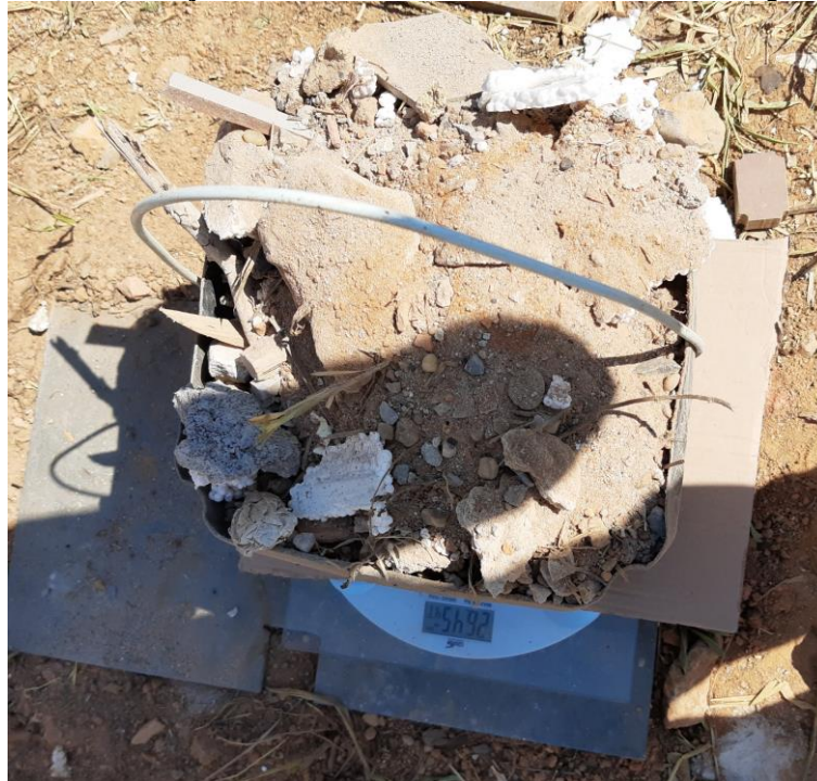
Figura 21 - Quantificação Amostra Resíduo Classe A (necessário para Etapa 2)
