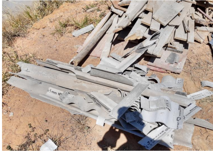
Figura 15 - Resíduos de Telha de Fibrocimento e de Madeira
