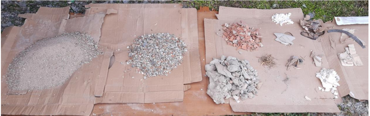
Figura 22 - Amostra Resíduos Classe A Separados em: Agregado Miúdo, Agregado Graúdo, Concreto e Argamassa, Material Cerâmico (Tijolo), Isopor, Papel, Plástico, Telha de Fibrocimento, Madeira, Material Cerâmico (Placas e Porcelanato), Gesso, Gesso Acartonado e Matéria Orgânica (Vegetação)
