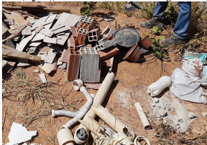
Figura 17 - Resíduos de Madeira, Material Cerâmico (Placas e Porcelanato), Material Cerâmico (Tijolos), Material Hidráulico e Lixo Orgânico
