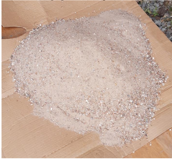
Figura 24 - Resíduo de Agregado Miúdo (passante na peneira de malha 4)
