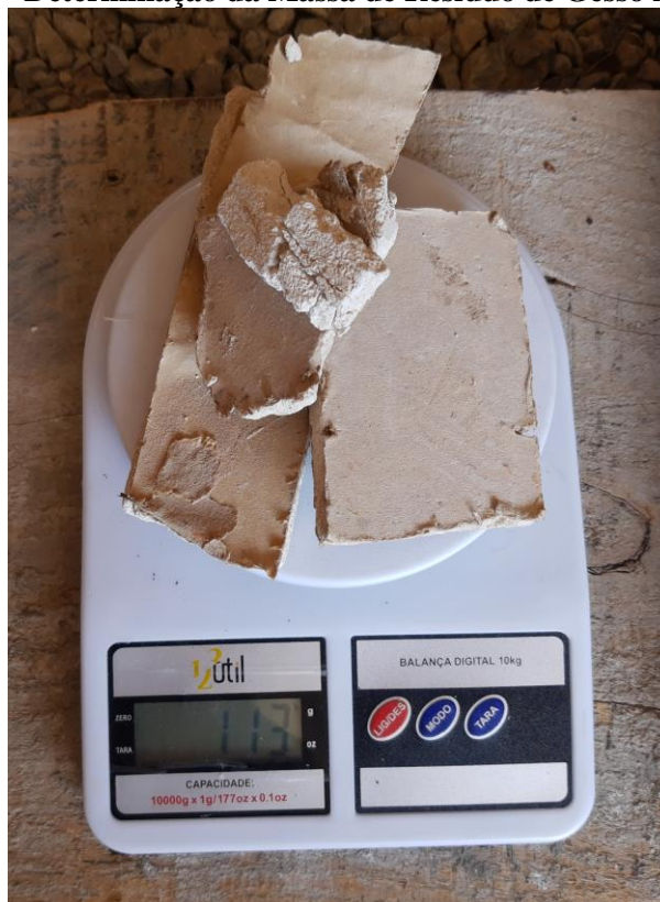
Figura 26 - Determinação da Massa de Resíduo de Gesso Acartonado
