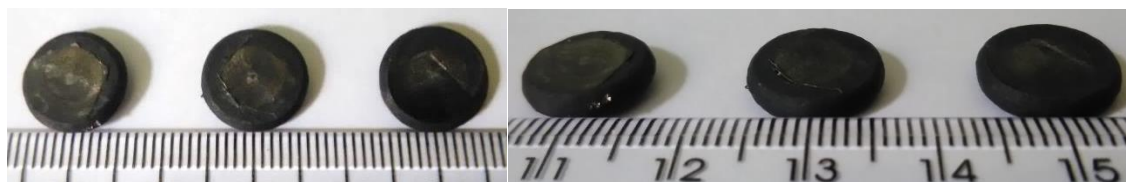
Figura A.10 Amostras da liga Ti-15%Mo após ensaio isotérmico de compressão a quente a 800 °C, com 0,172; 1,72 e 17,2 s -1 , da esquerda para a direita, respectivamente.
