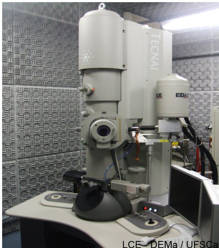
Figura 3.12 Microscópio de transmissão eletrônica FEI Tecnai G 2 F20 localizado no Laboratório de Caracterização Estrutural (LCE-DEMa) [138].
