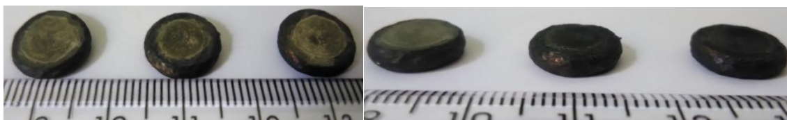
Figura A.3 Amostras da liga TMZF após ensaio isotérmico de compressão a quente a 800 °C, com 0,172; 1,72 e 17,2 s -1 , da esquerda para a direita, respectivamente.
