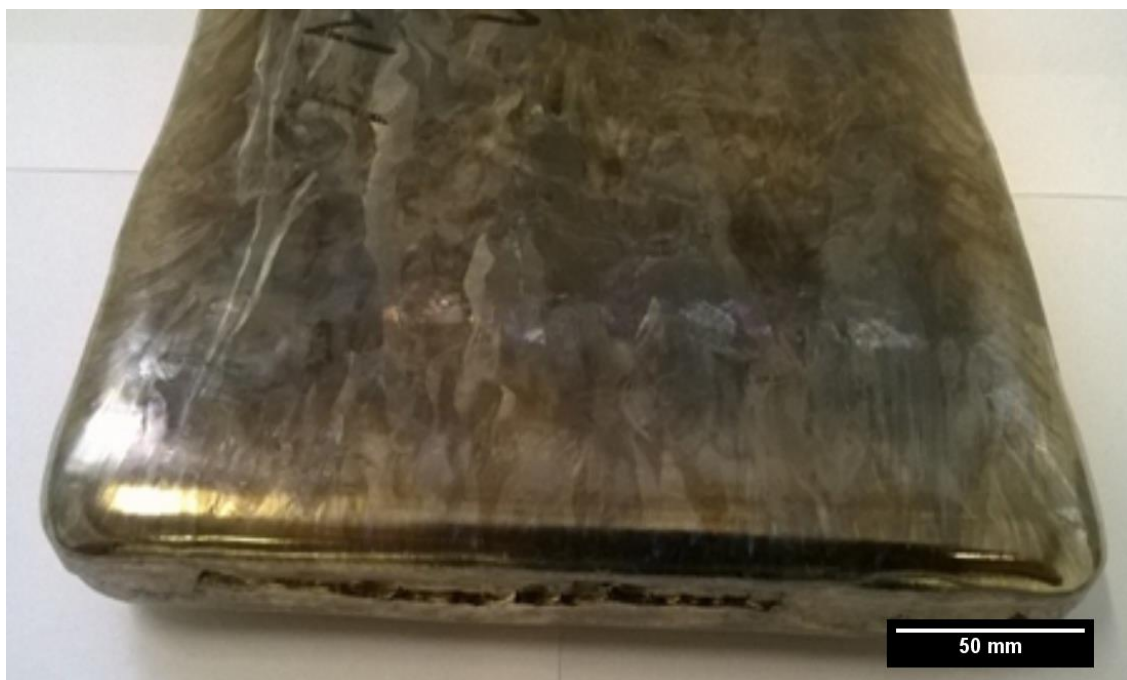
Figura 3.2 Parte do lingote da liga TMZF como recebida.
