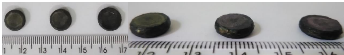
Figura 4.7 Amostras da liga TMZF após ensaio isotérmico de compressão a quente a 650 °C, com 0,172; 1,72 e 17,2 s -1 , da esquerda para a direita, respectivamente.
