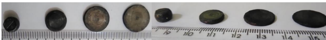
Figura 4.8 Amostras da liga TMZF após ensaio de deformação sob resfriamento contínuo por compressão a quente com intervalo entre passes de 5 segundos, da esquerda para a direita, 2 passes, 5 passes, 9 passes e 10 passes de deformação, respectivamente.
