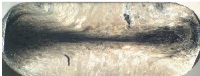
Figura 2.23 Fluxo de deformação plástica localizada em liga de Ti-1300 deformada a 890 \text{ °C} a 10 \text{ s}^{-1} [70].
