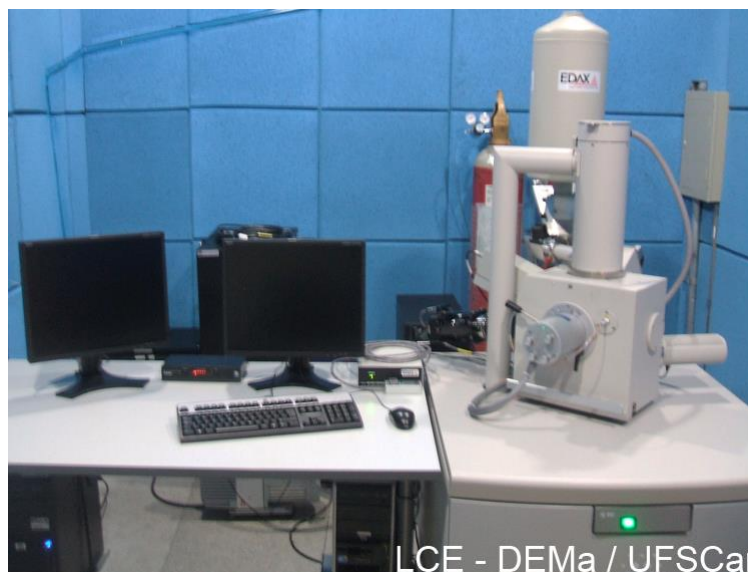
Figura 3.10 MEV FEI Inspect S50 com analisador de EBSD acoplado localizado no Laboratório de Caracterização Estrutural (LCE-DEMa) [138].
