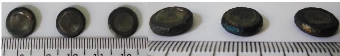
Figura A.4 Amostras da liga TMZF após ensaio isotérmico de compressão a quente a 850 °C, com 0,172; 1,72 e 17,2 s -1 , da esquerda para a direita, respectivamente.
