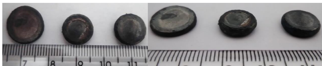
Figura A.5 Amostras da liga TMZF após ensaio isotérmico de compressão a quente a 900 °C, com 0,172; 1,72 e 17,2 s -1 , da esquerda para a direita, respectivamente.
