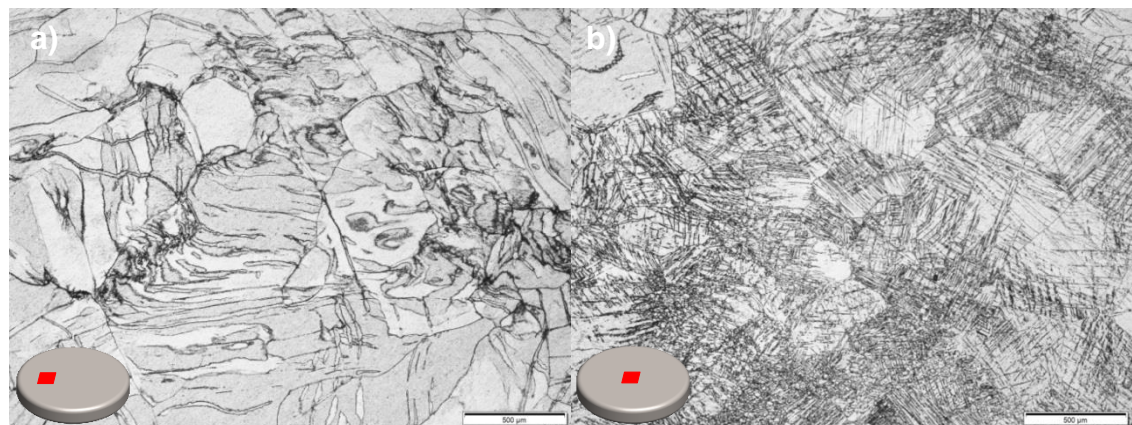
Figura 4.96 Microestrutura de liga Ti-15%Mo após ensaio de compressão a quente sob resfriamento contínuo e intervalo entre passes de 05 segundos após 5 passes de deformação. Em (a) região intermediária da amostra e em (b) região central.
