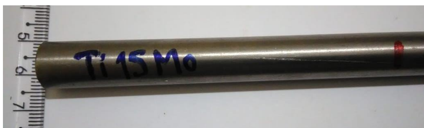
Figura 3.6 Barra de liga Ti-15%Mo como recebida.
