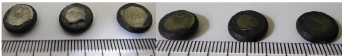
Figura A.9 Amostras da liga Ti-15%Mo após ensaio isotérmico de compressão a quente a 750 °C, com 0,172; 1,72 e 17,2 s -1 , da esquerda para a direita, respectivamente.
