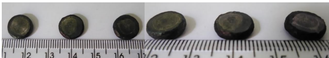
Figura A.1 Amostras da liga TMZF após ensaio isotérmico de compressão a quente a 700 °C, com 0,172; 1,72 e 17,2 s -1 , da esquerda para a direita, respectivamente.
