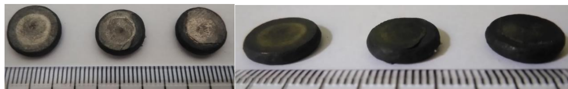
Figura A.11 Amostras da liga Ti-15%Mo após ensaio isotérmico de compressão a quente a 850 °C, com 0,172; 1,72 e 17,2 s -1 , da esquerda para a direita, respectivamente.
