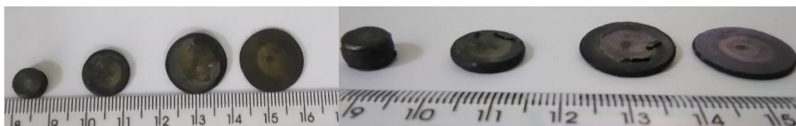
Figura A.14 Amostras da liga Ti-15%Mo após ensaio de deformação sob resfriamento contínuo por compressão a quente com intervalo entre passes de 50 segundos, da esquerda para a direita, 2 passes, 5 passes e 10 passes de deformação, respectivamente.
