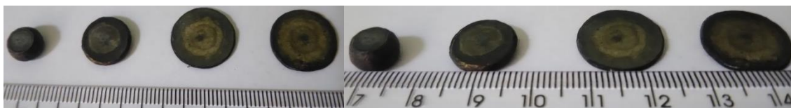
Figura A.6 Amostras da liga TMZF após ensaio de deformação sob resfriamento contínuo por compressão a quente com intervalo entre passes de 20 segundos, da
