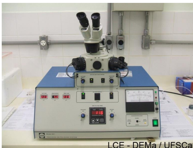
Figura 3.11 Sistema de Polimento Iônico de Precisão (PIPS), Gatan modelo 691 localizado no Laboratório de Caracterização Estrutural (LCE-DEMa) [138].
