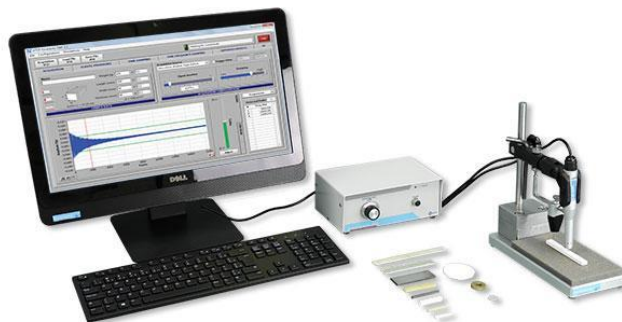
Figura 3.7 Ilustração de tipo de equipamento utilizado na determinação de módulo elástico via excitação por impulso, ATPC Sonoelastic [137].
