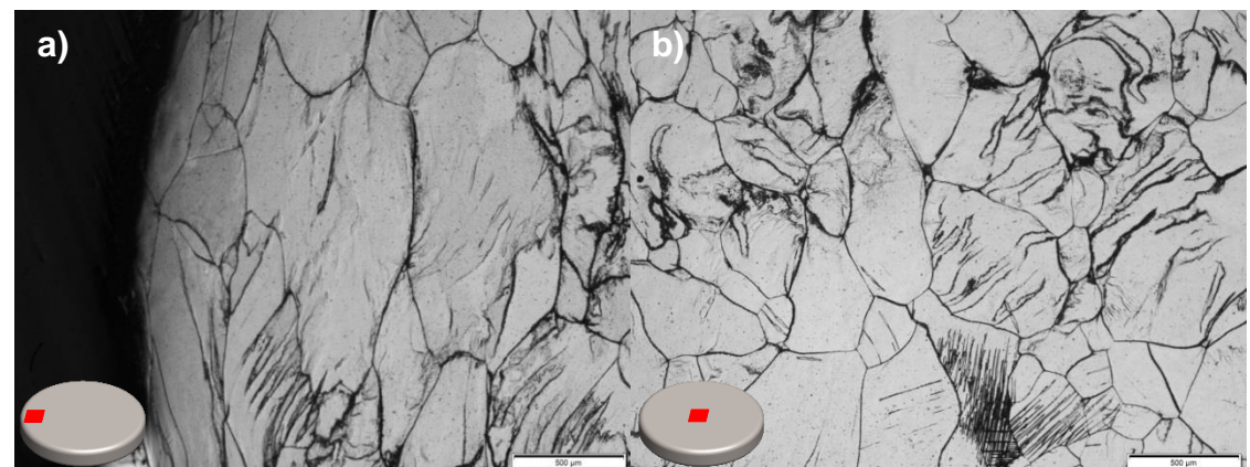
Figura 4.97 Microestrutura de liga Ti-15%Mo após ensaio de compressão a quente sob resfriamento contínuo e intervalo entre passes de 05 segundos após 9 passes de deformação. Em (a) borda da amostra e em (b) região central.
