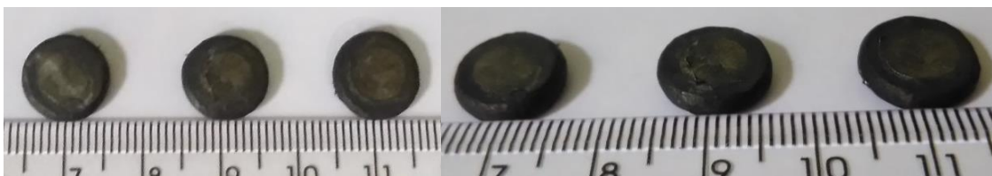
Figura A.8 Amostras da liga Ti-15%Mo após ensaio isotérmico de compressão a quente a 700 °C, com 0,172; 1,72 e 17,2 s -1 , da esquerda para a direita, respectivamente.
