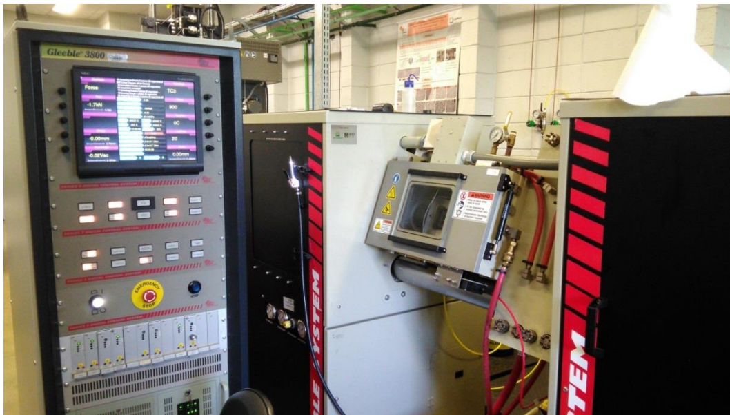
Figura 3.16 Equipamento utilizado nos ensaios termomecânicos Gleeble 3800, situado no LLNano/CNPEM em Campinas/SP.
