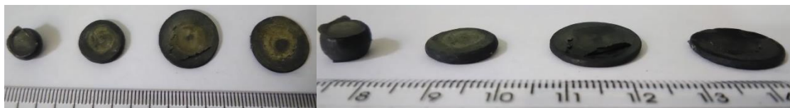
Figura A.13 Amostras da liga Ti-15%Mo após ensaio de deformação sob resfriamento contínuo por compressão a quente com intervalo entre passes de 20 segundos, da esquerda para a direita, 2 passes, 5 passes e 10 passes de deformação, respectivamente.
