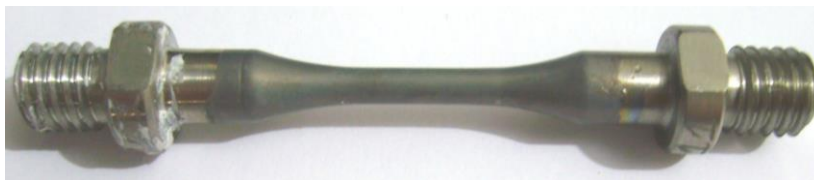
Figura 3.5 Foto de um dos corpos de prova após modificação da superfície por oxidação eletroquímica.
