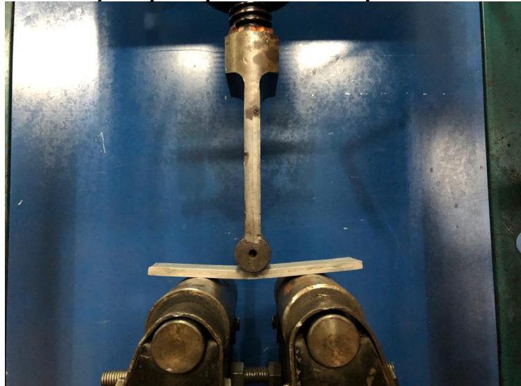
Figura 38 - Corpo de prova posicionado no dispositivo antes da dobra.
