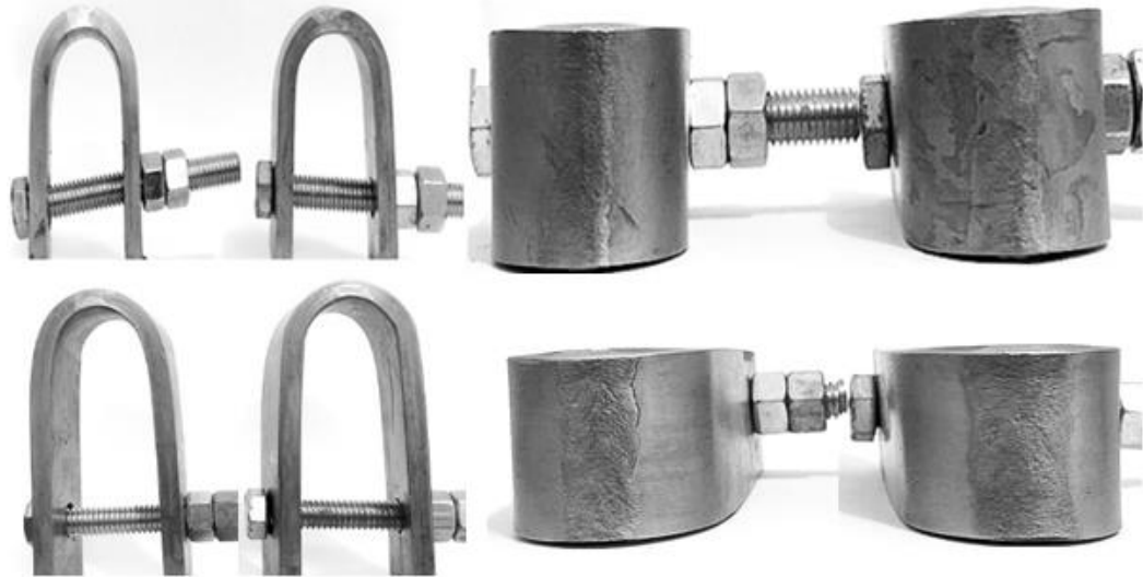
Figura 48 - Vistas laterais dos corpos de provas dobrados, amostras BA (acima) e AA (abaixo).
