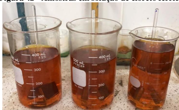
Figura 42 - Amostras em solução de cloreto férrico.
