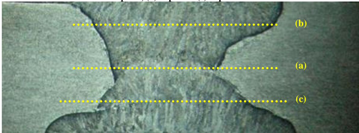
Figura 35 – Os pontos de indentação na seção na amostra BA, onde (a) linha que passa no 1º passe; (b) 2º passe e (c) 3º passe.
