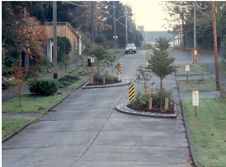
Figura 17 - Exemplo de deflexão horizontal.
