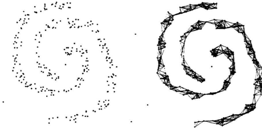
Figura 10 – Rede gerada a partir de um conjunto de dados utilizando o algoritmo Mk -NN.
