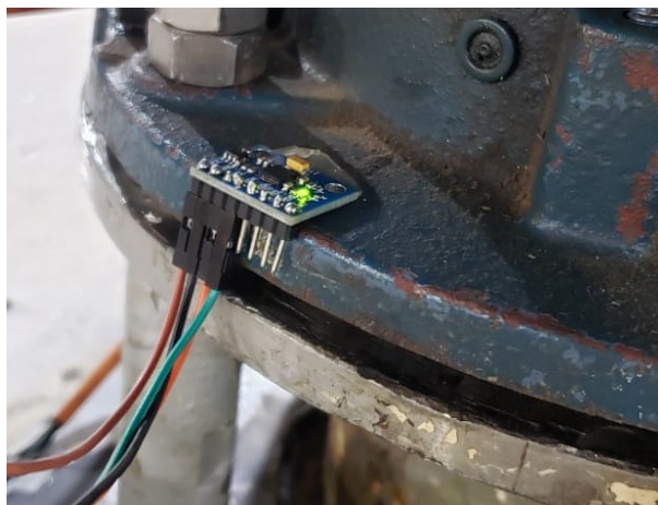
Figura 10 – Fixação Sensor MPU6050 no motor em estudo
