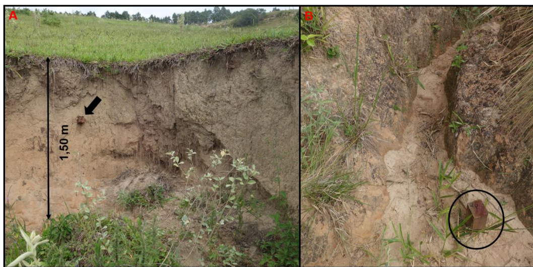
Figura 31. a) cabeceira principal da voçoroca e destaque para estaca na parede. b) estacas no chão da voçoroca.
