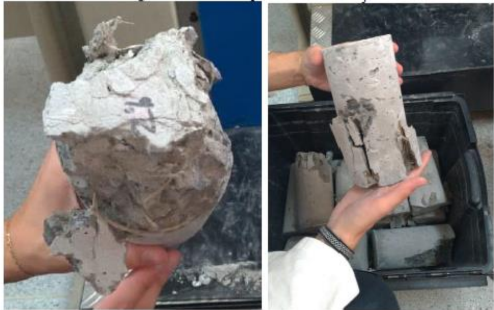
Figura 10. Ruptura de concreto reforçado com fibra de soja.
