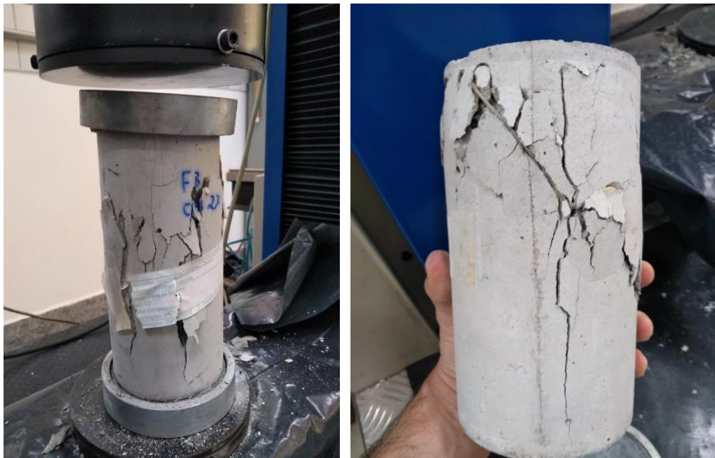
Figura 11. Ruptura de concreto reforçado com fibra de bambu.
