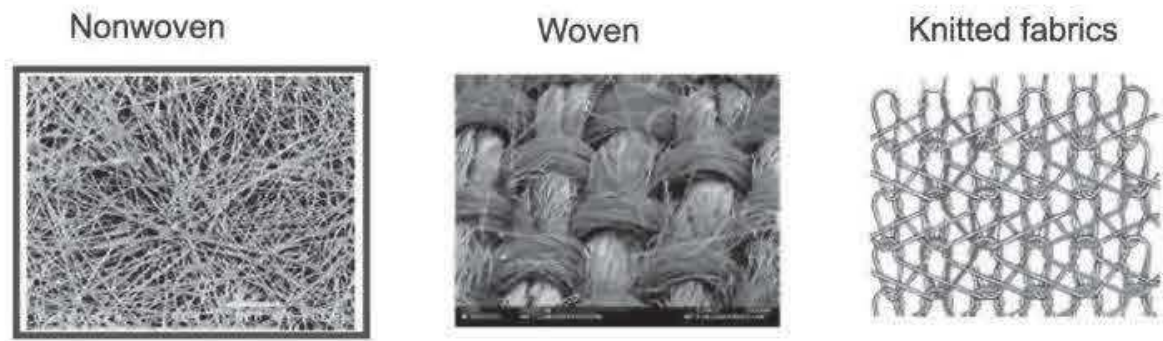
Figura 8 – Estrutura de tecidos não-tecidos ( nonwoven ), tecidos feitos a partir da tecelagem ( woven ) e tecidos feitos por tricô ( knitted fabrics ).
