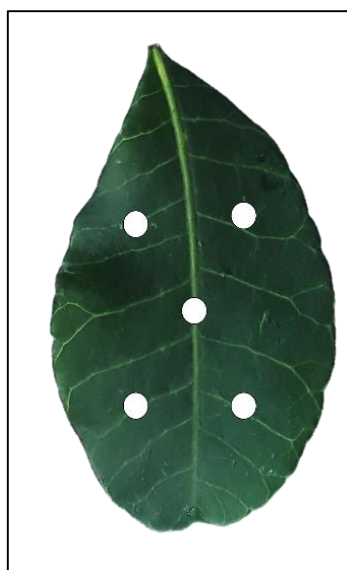
Figura 3.4. Esquema para a determinação da cor das folhas, in natura e secas.
