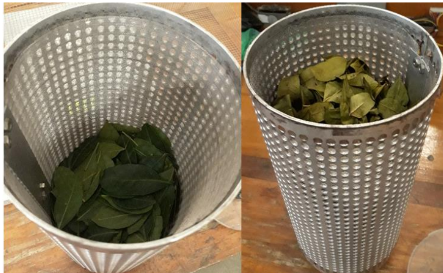
Figura 3.11. Secagem em tambor rotativo utilizando 200g de folhas (a) Início; (b) Final
