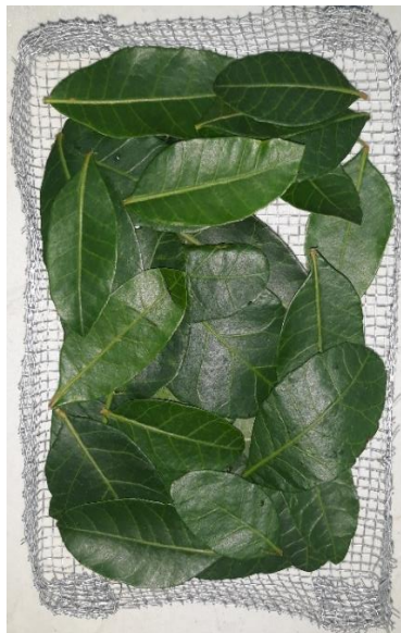
Figura 3.6. Amostra de 10g de folhas dispostas em bandejas perfuradas de alumínio para a secagem em estufa com convecção natural.
