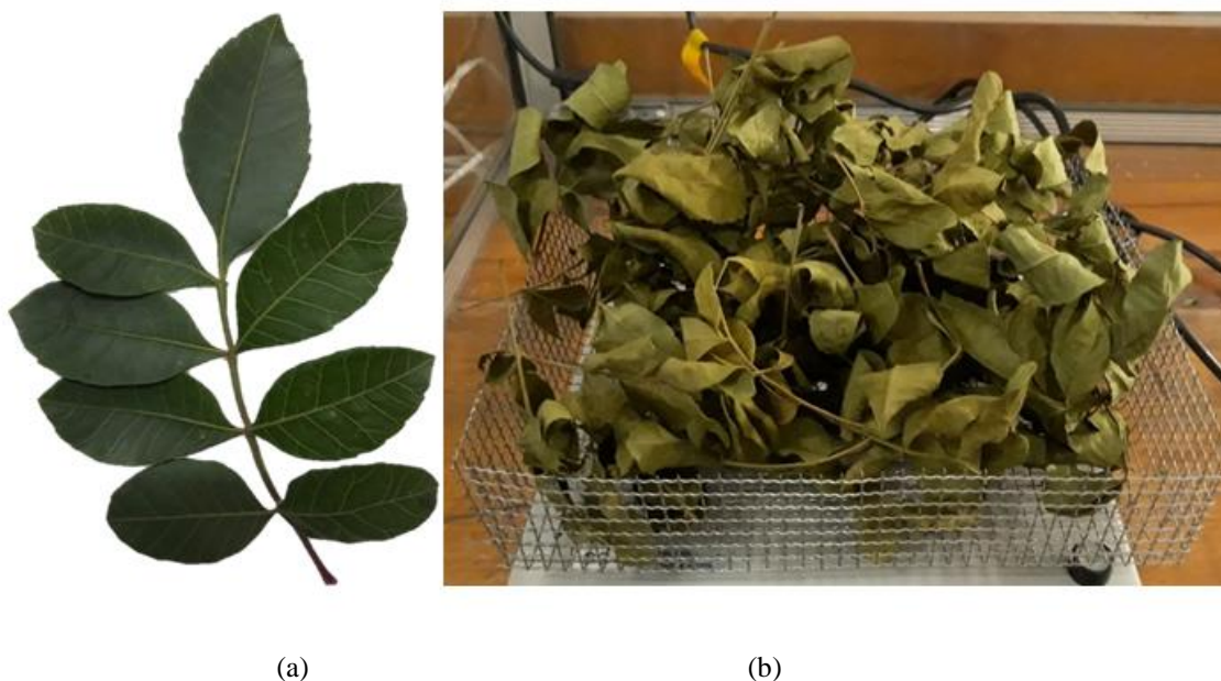
Figura 3.10. (a) Ramo de aroeira constituído por uma haste central com 8 folhas; (b) Ramos secos no final do processo (massa inicial 100 g).
