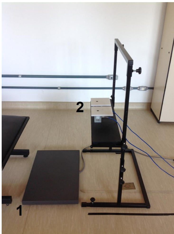
Figura 4. Equipamentos utilizados no procedimento experimental (1): Plataforma de força, (2) Célula de carga. Fonte: Acervo pessoal.
