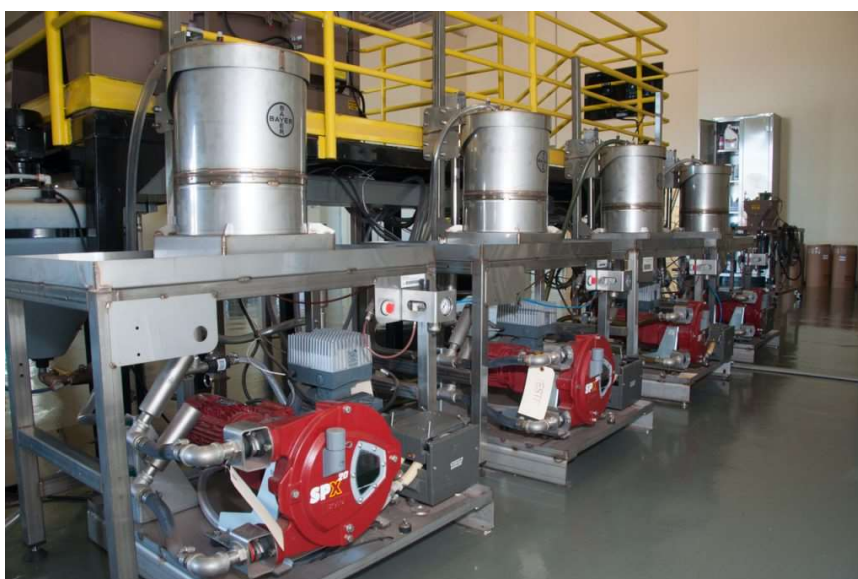
Figura 8. Tratador contínuo por bateladas (CBT) para tratamento de sementes industrial (TSI). Foto: Bayer SeedGrowth (2021).
