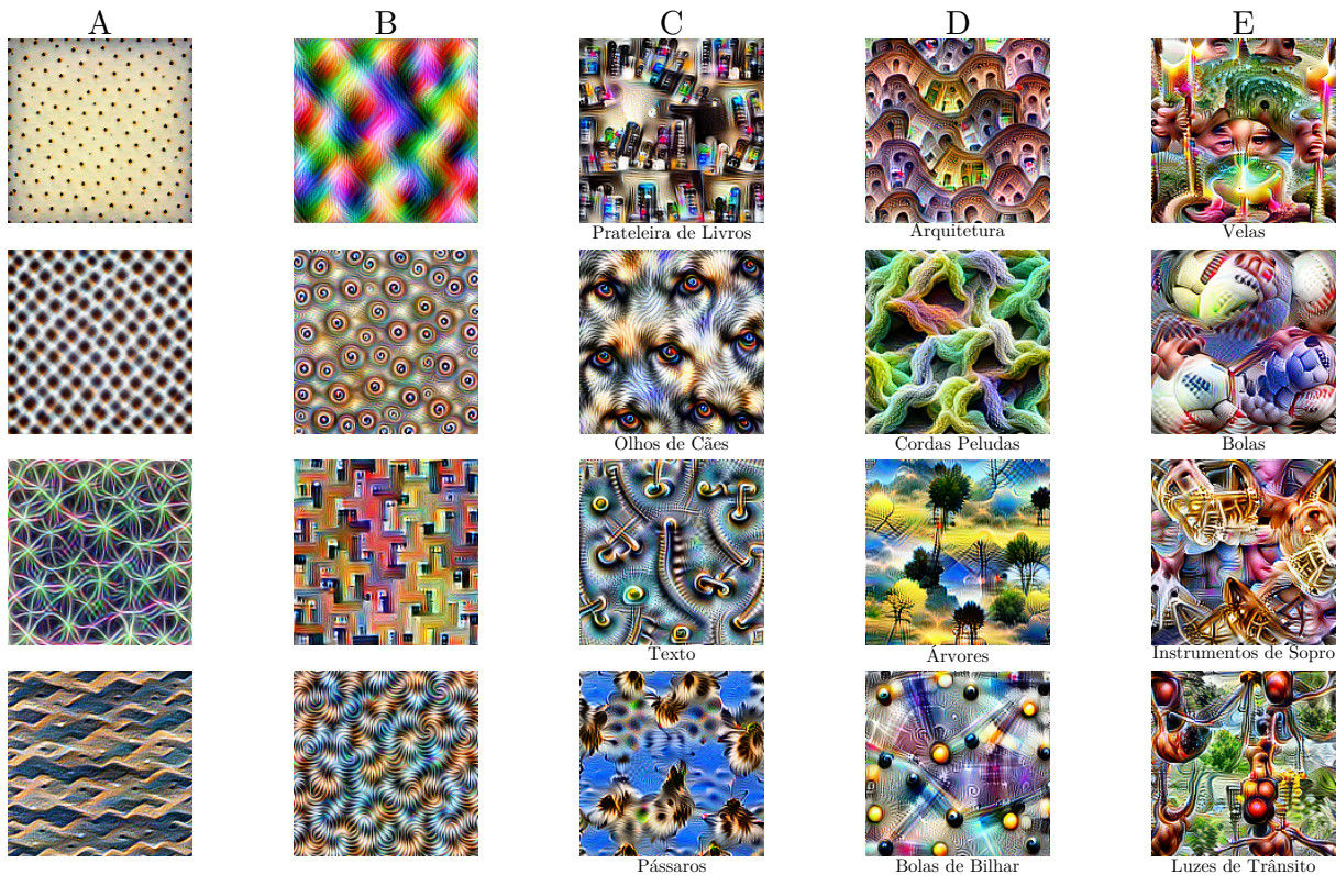
Figura 2.10 – Evolução das estruturas reconhecidas por cada neurônio em uma CNN. (A e B) - Nas primeiras camadas da rede, usualmente são reconhecidas apenas estruturas simples e mais gerais, como pontos, bordas, cantos e círculos. (C) - As camadas centrais da rede são frequentemente ativadas por partes de objetos mais reconhecíveis pelo ser humano. (D e E) - Ao final dessa rede os neurônios possuem maior poder de abstração, reconhecendo estruturas mais complexas, como árvores, bolas e instrumentos de sopro em geral. Adaptado de Olah, Mordvintsev e Schubert (2017).
