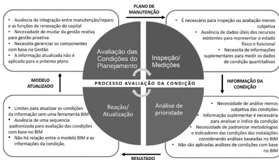
Figura 4 - Processo de avaliação das condições atuais da manutenção
