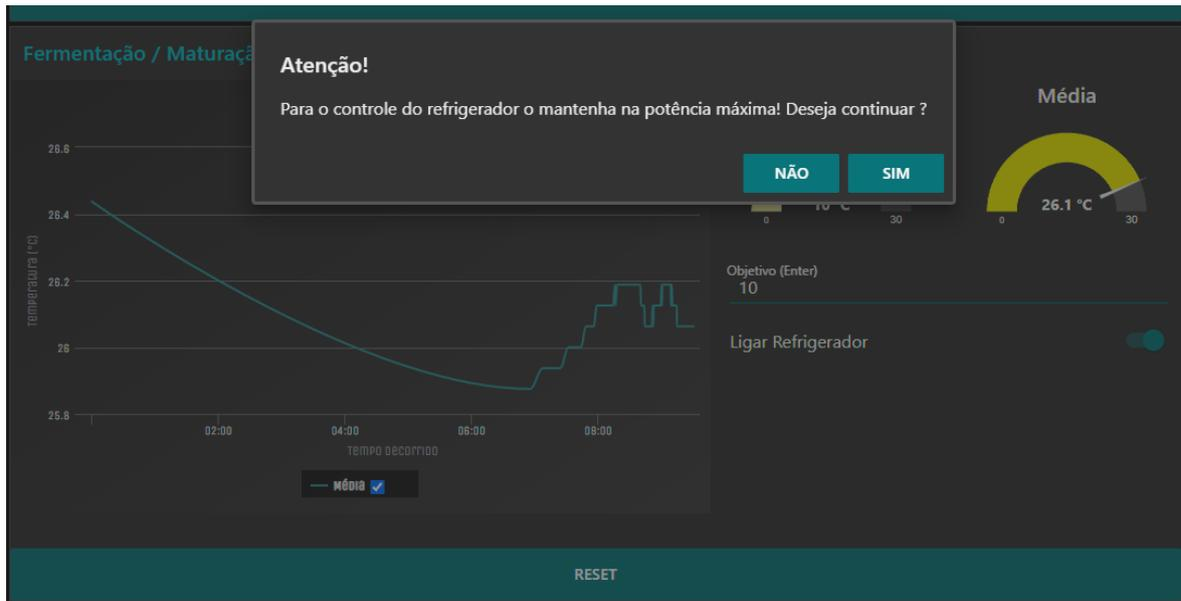
O controle é do tipo On/Off com uma histerese de 1°C, sendo o acionamento do relé mecânico realizado pelo nó “Controle Refrigerador”. Nesse fluxo em específico, quando não se é determinado um setpoint e o nó “Ligar Refrigerador” é alterado para a posição On, o refrigerador é acionado normalmente sem qualquer tipo de controle por parte do programa.
