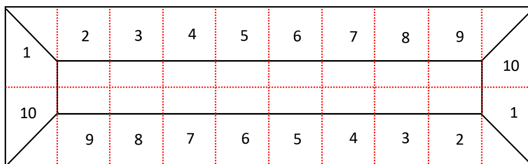
FIGURA 4.6 – Diagrama demonstrativo com um exemplo de quarteamento com uma pilha longitudinal, onde a numeração de 1 a 10 representa as frações da pilha.
