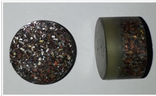
FIGURA 5.4 - Amostra imobilizada em resina epóxi após a etapa de lixamento e polimento da superfície.
