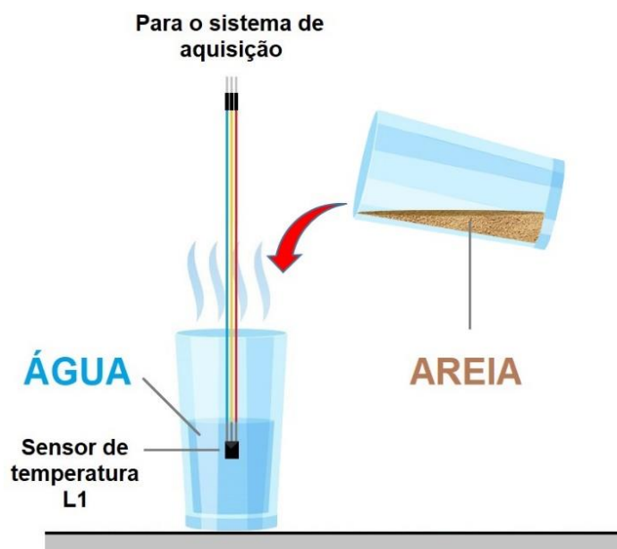
Figura 3: Representação esquemática da introdução da areia no copo que contem a água.
