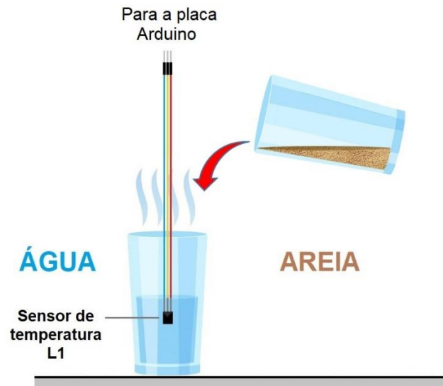
Figura 3: Representação esquemática da introdução da areia no copo que contem a água.
