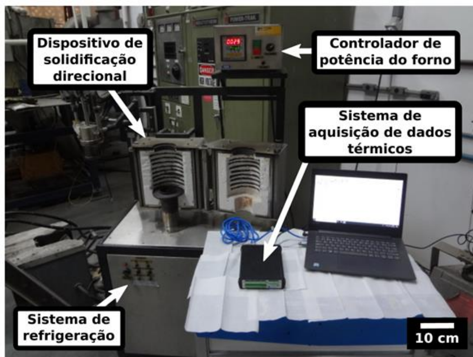
Figura 3.3 - Fotografia do sistema experimental que foi utilizado no experimento de solidificação unidirecional vertical ascendente.
