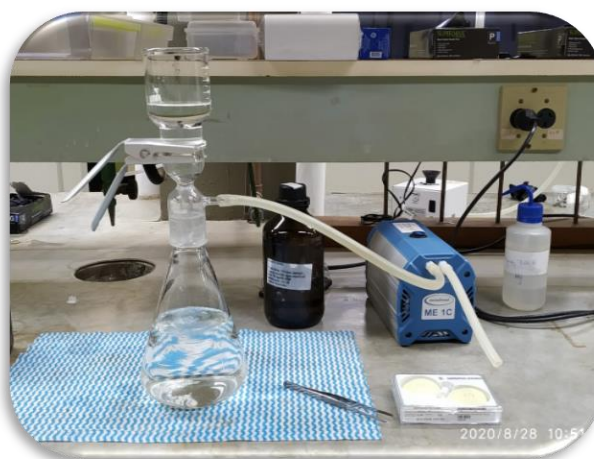
FIGURA 4.2- Representação do sistema usado para filtrar as amostras de água.
