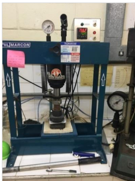
FIGURA 4. 2 - Prensa utilizada para a vulcanização dos nanocompósitos f-MoS 2 /PB.
