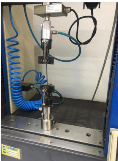
FIGURA 4. 3 - Máquina de ensaio de tração utilizada para os ensaios de tensão-deformação.
