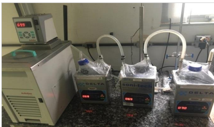
FIGURA 4. 1 - Esquema de síntese do f-MoS 2 em banho termostático.
