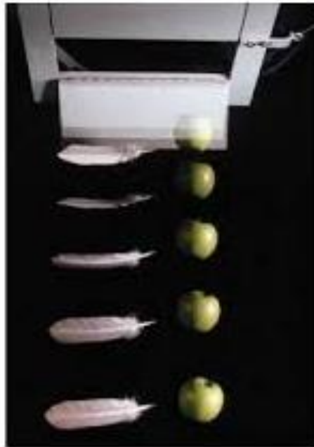
Figura 4.4: Sequência de fotos estroboscópicas de bola e pena em queda livre no vácuo
