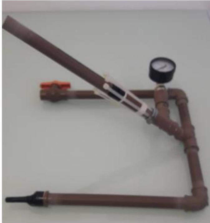
Figura 5.26 – Base de lançamento
