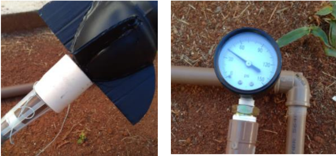
Figura 19: gatilho encaixado e manômetro indicando pressão de 40 psi.
