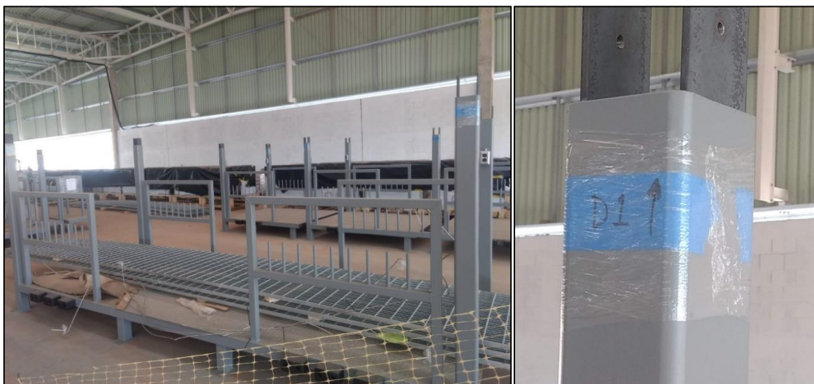
Figura 33 - Poke-Yoke para garantia de montagem correta de plataforma
