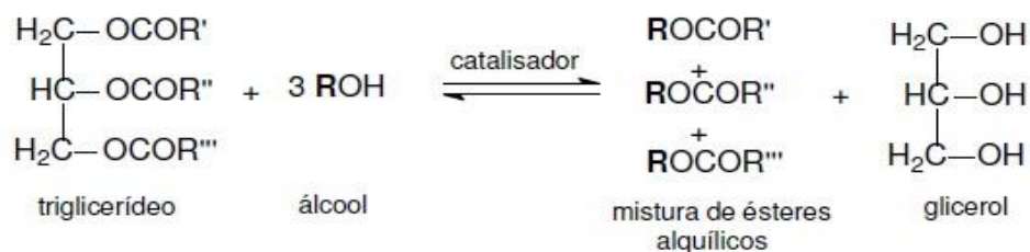
Figura 5 – Reação de transesterificação. Fonte: (GARCIA, 2006)
