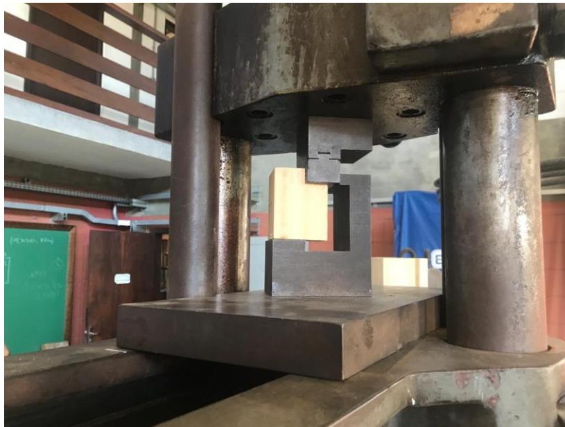
Figura 3.5: Ensaio de cisalhamento com corpo de prova de Caixeta
