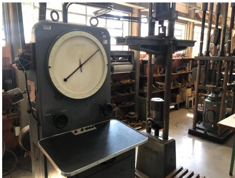
Figura 3.1: Máquina AMSLER (ensaio mecânicos)
