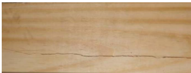
Figura 1.2: Falha por cisalhamento longitudinal
