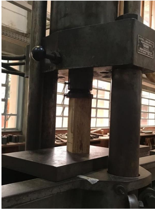
Figura 3.8: Ensaio de compressão paralela com o corpo de prova de Tauari
