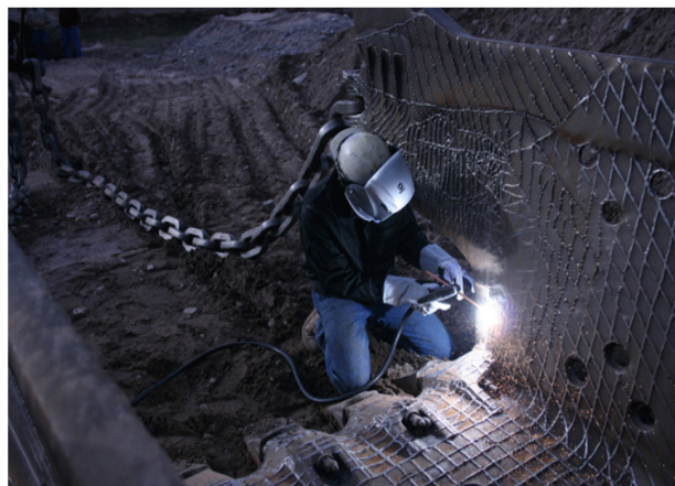
Figura 3.8 – Imagem da aplicação de revestimento duro por enxadrezamento em uma carregadeira.
