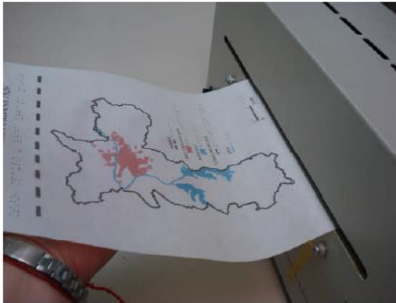
Fotografia 3 – Mapa saindo da máquina com as linhas impressas em preto e em relevo Fonte: Acervo de Mapas Táteis do LEMADI (CARMO, 2009, p. 71)
