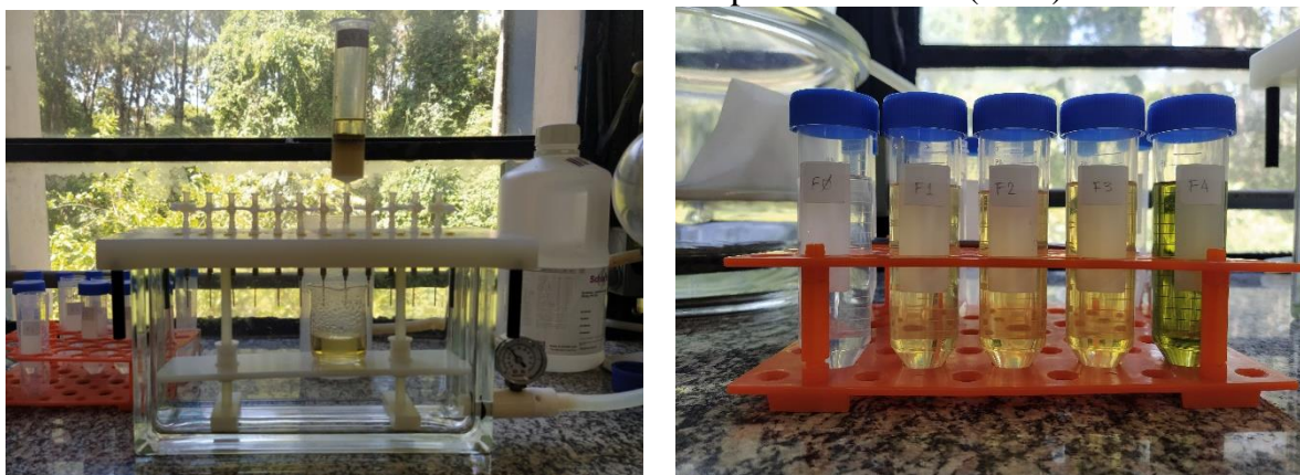
FIGURA 4.3 - Sistema de extração em fase sólida e as frações coletadas no fracionamento do extrato das folhas da aroeira-preta cultivada (AFL).
