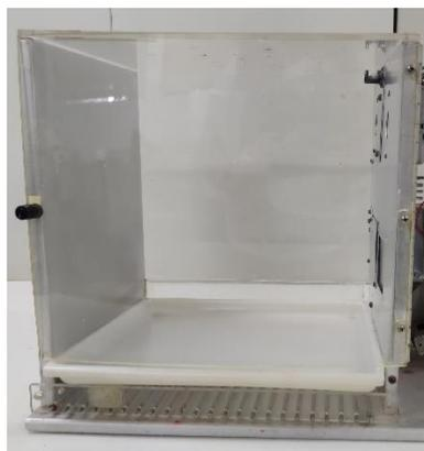
**Figura 2.** Fotografia da caixa experimental utilizada para observação da autolimpeza.
